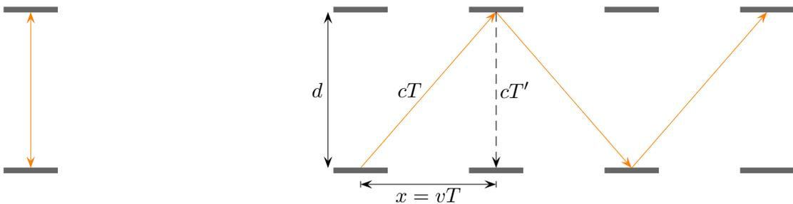
Ein Beobachter der Lichtuhr im bewegten  $x'y'$ -System misst für die Laufzeit eines Lichtsignals zwischen den Spiegeln die Zeitdauer  $T' = \frac{d}{c}$ ,  $d = cT'$ .
