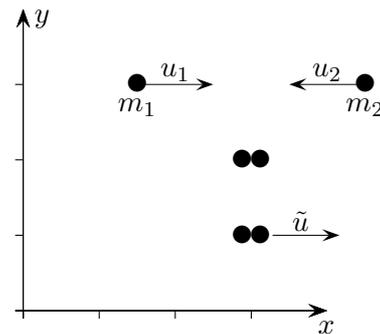
Für den inelastischen Stoß mit  $m'_1 = m'_2$  und den Geschwindigkeiten  $u'_1 = v$  und  $u'_2 = -v$  (siehe Grafik) ist nach dem Stoß  $\tilde{u}' = 0$ . Aus Sicht des  $xy$ -Systems bewegen sich dann beide Massen mit der Geschwindigkeit  $v$ .
