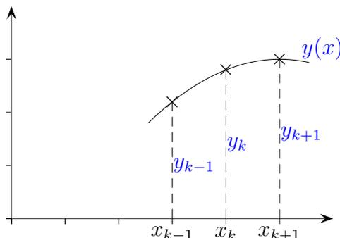
Wir befinden uns an der Stelle  $x_k$ , haben die Werte  $y_k, y_{k-1}$  usw. ermittelt und suchen  $y_{k+1}$ . Zuerst stellen wir (z. B.) mit 3 Stützstellen  $x_{k-1}, x_k, x_{k+1}$  und den Stützwerten  $y_{k-1}, y_k, y_{k+1}$  das Lagrange-Polynom 2. Grades auf.
