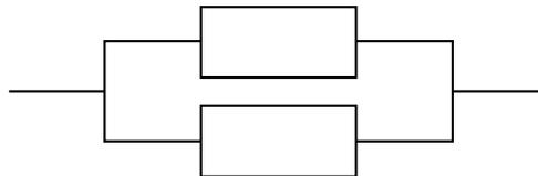
Ein Parallelsystem funktioniert genau dann, wenn mindestens ein Bauteil funktioniert.
