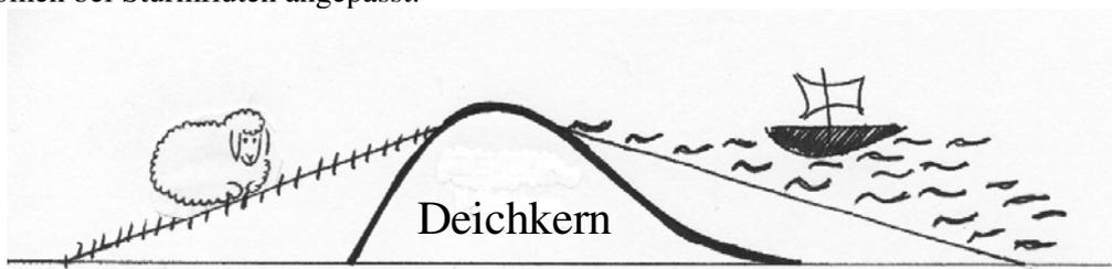
Die Deiche bestehen aus einem so genannten Deichkern und zum Land und zum Wasser hin auslaufenden Wällen. Der Kern eines solchen Deiches kann durch die Funktion  $f_{a,b}$  mit
